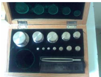
Σετ βαρών για εφαρμογή σταθερής τάνυσης στο νήμα.
